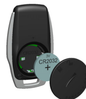
Figura 1 Cambio de Batería
